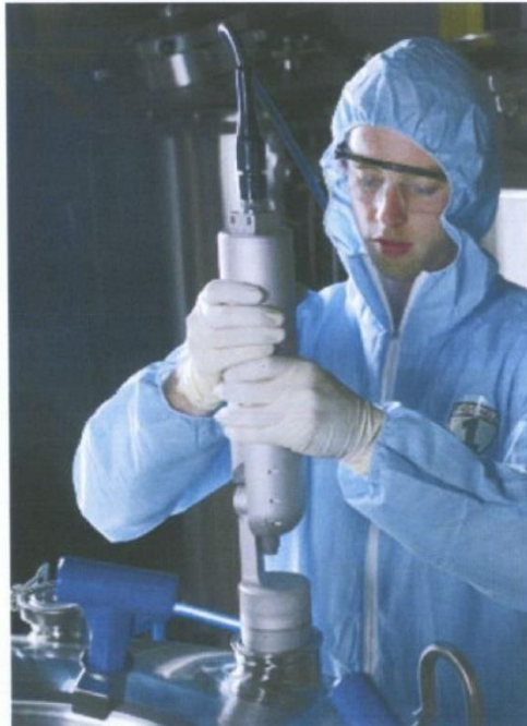
ÜBERPRÜFUNG DER SPRÜHKOPFABDECKUNG ZUR SICHERUNG PHARMAZEUTISCHER REINIGUNG
