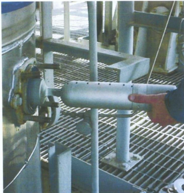
INSPEKTION VON FILTERBÖDEN IN GLAS AUSGEKLEIDETEN BEHÄLTERN
